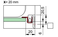
d) mit Dichtprofil 8861KU0-8 und Türanschlag-Trägerprofil 8880
