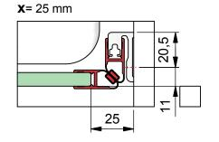
c) mit Dichtprofil 8855KU0-8 und Türanschlag-Trägerprofil 8880
