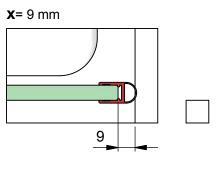
b) mit Dichtprofil 8851KU0-8 und Türanschlag-Trägerprofil 8880
