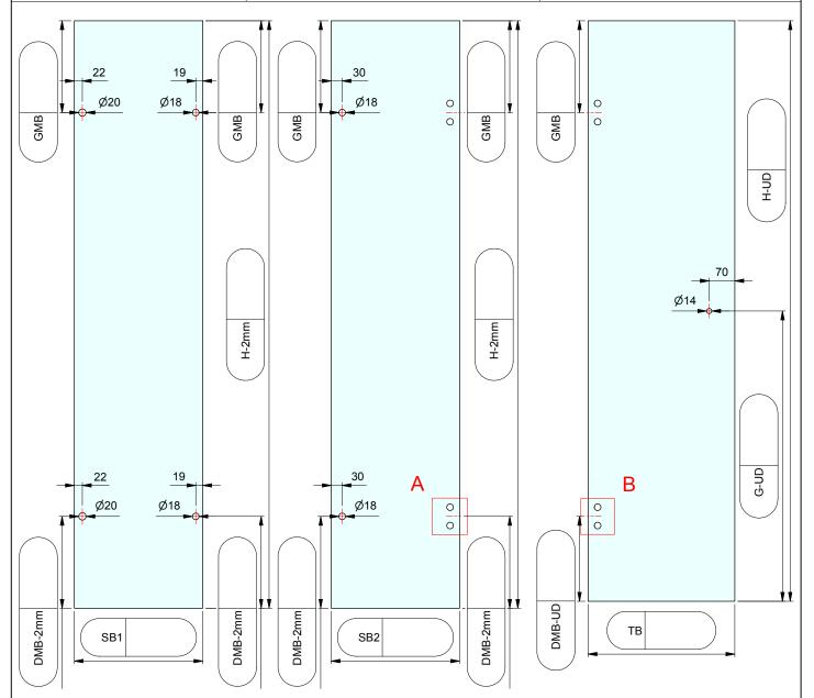
ESG 8mm klar gefertigt nach DIN EN14428 (Duschenglas). Ein entsprechender Nachweis(Stempel) ist erforderlich. Kanten umlaufend geschliffen und poliert. Alle Ecken stoßen oder leicht runden.
