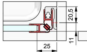
c) mit Dichtprofil 8855KU0-8 und Türanschlag-Trägerprofil 8880
