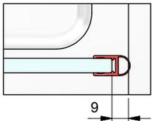
b) mit Dichtprofil 8851KU0-8 und Türanschlag-Trägerprofil 8880
