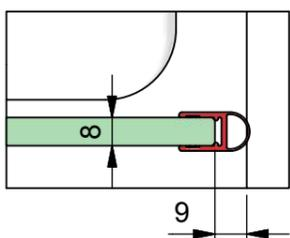
b) mit Dichtprofil 8851KU0-8 und Türanschlag-Trägerprofil 8880
