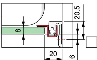
d) mit Dichtprofil 8861KU0-8 und Türanschlag-Trägerprofil 8880
