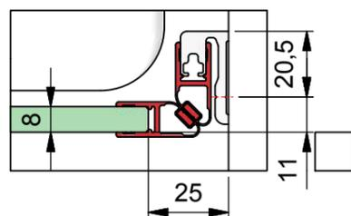
**Achtung:** Vorallem bei kleinen Türflügeln ist durch den aussen liegenden Drehpunkt die Kompression des Dichtprofils erhöht. Beim Schließen und Öffnen ist mehr Kraftaufwand erforderlich.
