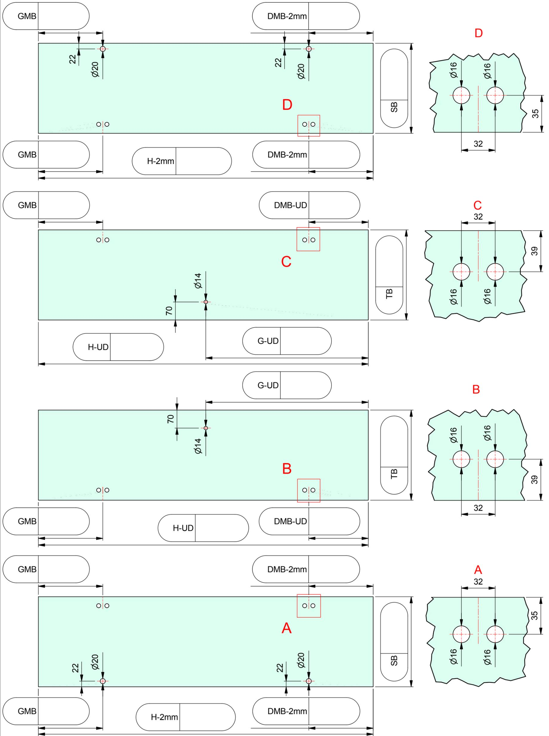
ESG 8mm klar gefertigt nach DIN EN14428 (Duschenglas). Ein entsprechender Nachweis(Stempel) ist erforderlich. Kanten umlaufend geschliffen und poliert. Alle Ecken stoßen oder leicht runden.
