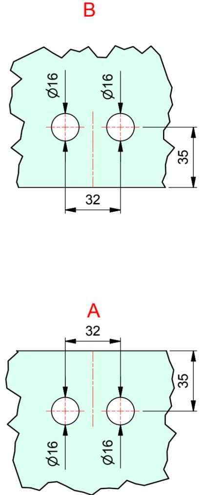
ESG 8mm klar gefertigt nach DIN EN14428 (Duschenglas). Ein entsprechender Nachweis(Stempel) ist erforderlich. Kanten umlaufend geschliffen und poliert. Alle Ecken stoßen oder leicht runden.
