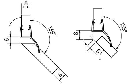
Abbildung zeigt Dichtung für 8 mm Glasstärke
