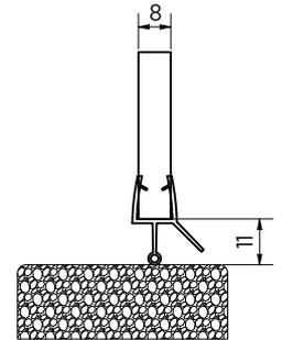
Abbildung zeigt Dichtung für 8 mm Glasstärke
