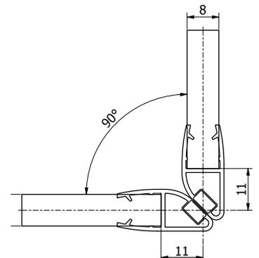
Abbildung zeigt Dichtung für 8 mm Glasstärke
