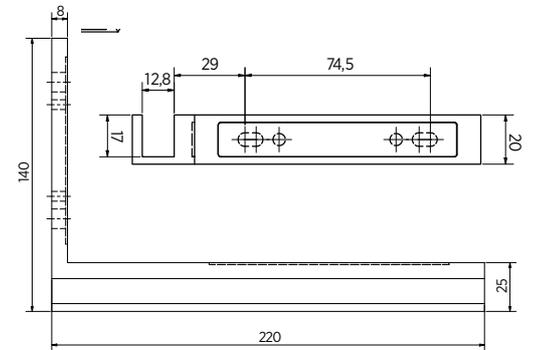
Abbildung zeigt Stabilisierungswinkel von unten
