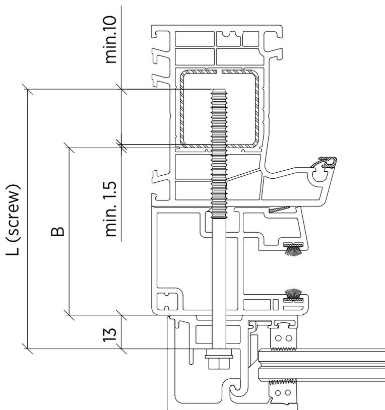
$L_{\text{min. screw}} = B + 25\text{mm}$
