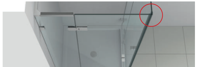
Art.-Nr. 8867KU0-8-R500 gebogen für Wannenradius R500 – 550 für 6 und 8 mm Glas Abwicklung = 1194 mm
