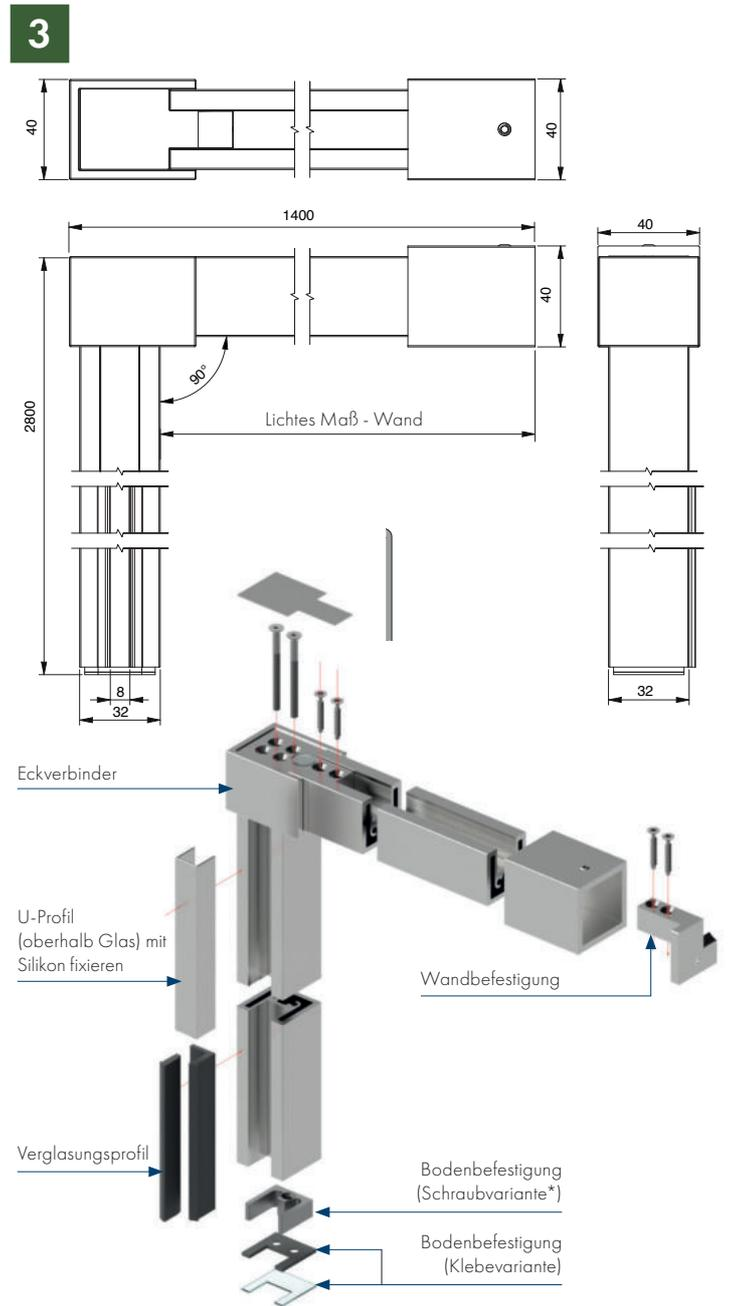
\* Damit die Wassersperre im Bad durch das nachträgliche Anbohren der unteren Befestigungsplatte nicht verletzt wird, sollte der Fliesenleger den Befestigungsadapter vorher in den Bodenaufbau einarbeiten und entsprechend der Beanspruchungskategorie die richtige Feuchtraumabdichtung nach den anerkannten Richtlinien ausführen.
