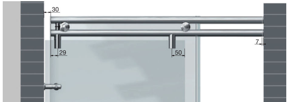
Beispiel Nischendusche mit Doppelaufrohr
