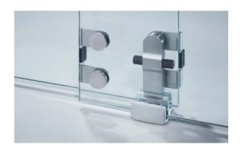
Bei Portavant 150 multiline lassen sich die Türflügel mit nur einem Handgriff gleichzeitig zur Seite schieben. SOFT CATCH sorgt für eine sukzessive Mitnahme der folgenden Schiebeflügel. In den Mitnehmern integrierte Dämpfer sichern eine sanfte und leise Mitnahme.
