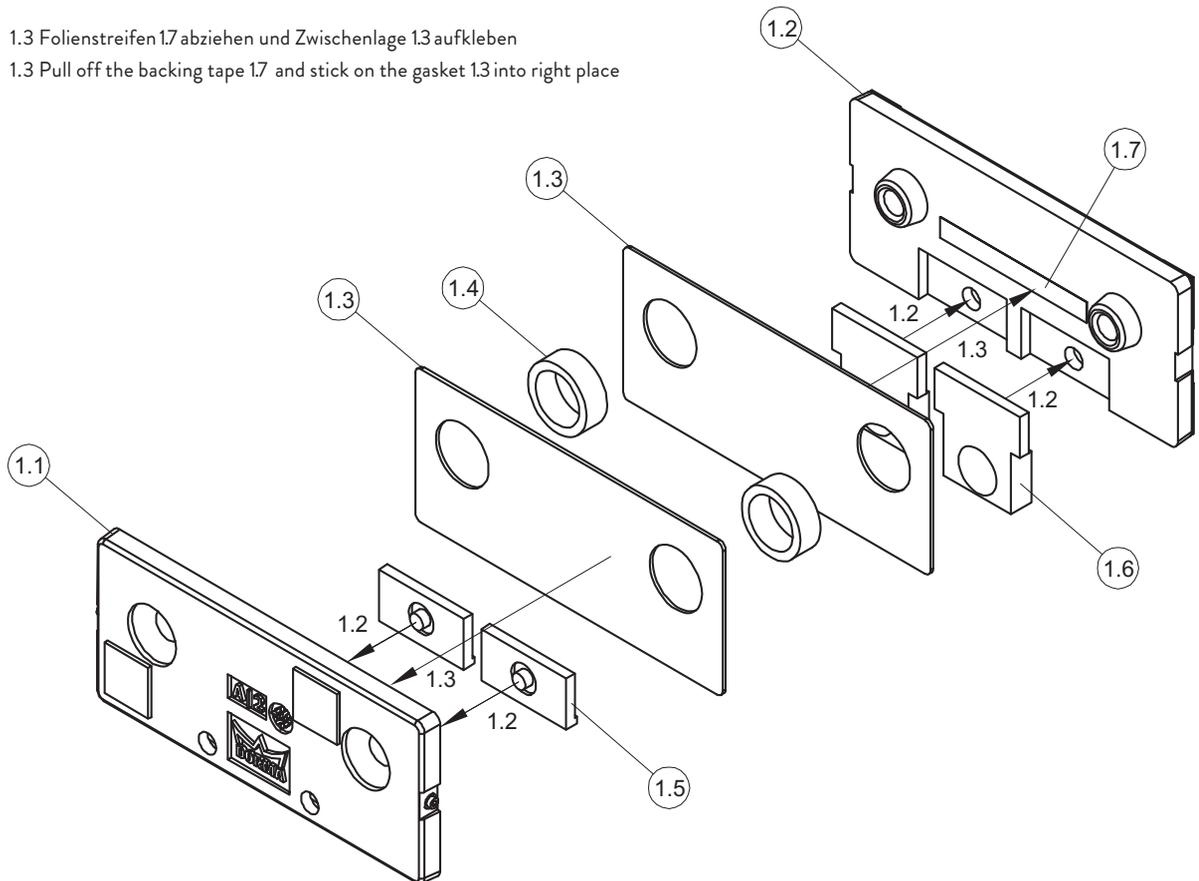
**2. Montage Grundkörper****2. Installation of base unit**
