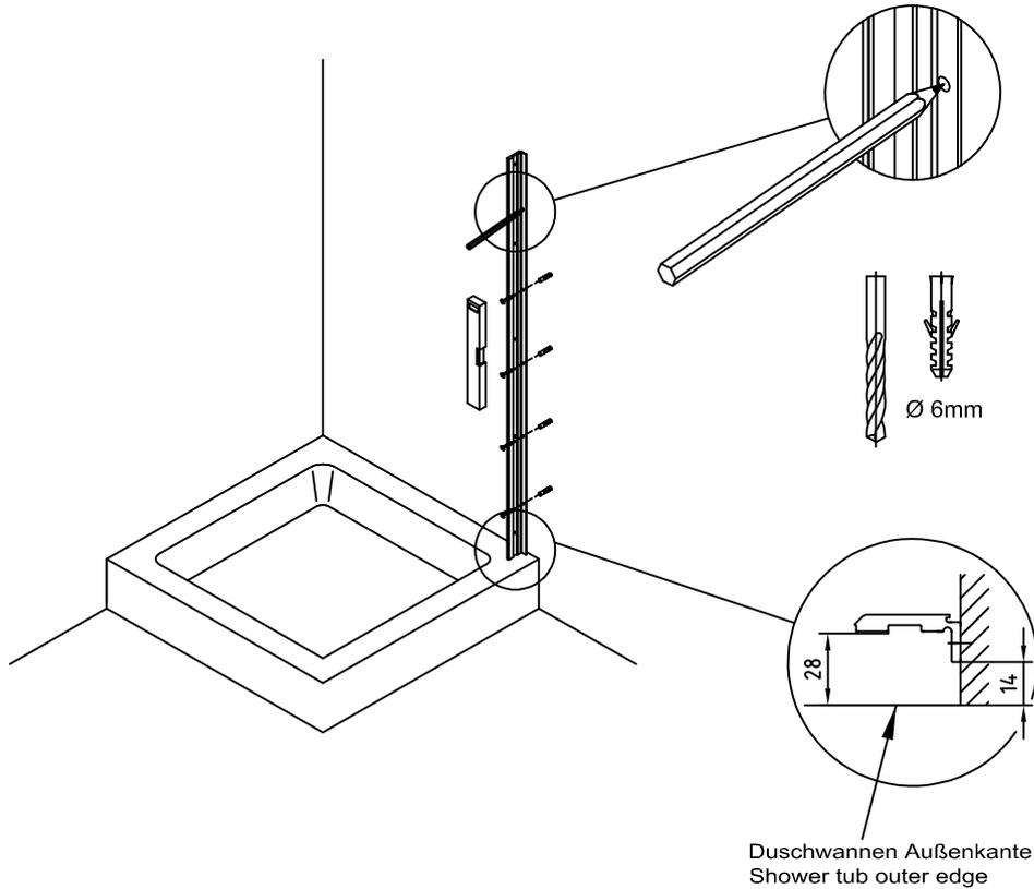
Seitenteil ausrichten und Klemmstücke anschrauben.
