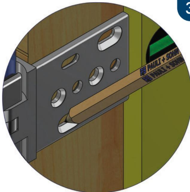
Aufsetzen des Türflügels auf den Boden- bzw. Sockelrand mit den vormontierten Sauna-Pendeltürband um die Position der Befestigungsbohrungen für die Wandlaschen anzuzeichnen. Um den späteren Abstand für das untere Spaltmaß sicherzustellen, sollte der Türflügel mit Montageklötzen in der Höhe des beabsichtigten Abzugsmaßes unterklötzt werden.
