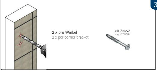
Wichtig: Schrauben und Dübel müssen an die jeweilige bauliche Situation angepasst sein! Der Bohrer ist entsprechend der Größe der Dübel zu wählen. Die Schrauben sollten aus Edelstahl A2 oder A4 bestehen und einen Senkkopfdurchmesser von min. 10 mm und max. 12 mm aufweisen.
