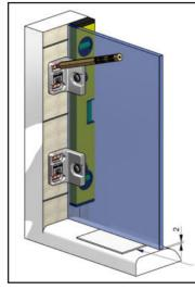
min. 2mm Unterlegematerial (klare PVC-Streifen, z.B. 8870KUO o.Ä.) min. 2mm clear PVC-strip e.q.8870KUO o.Ä.
