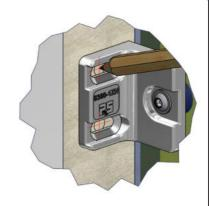
Aufsetzen des Seitenteils auf den Wannen- bzw. Duschtassenrand mit den vormontierten Winkeln, um die Position der Bohrungen für die Wandlaschen anzuzeichnen. Position the door wing with the pre-assembled shower hinges on the bath tub resp. Shower tray edge to mark the drillings for the wall mounting plates.
