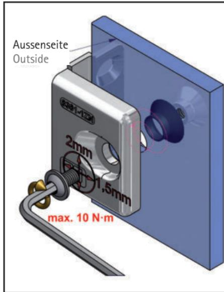
Die Befestigungsschraube mittig in Bohrung positionieren, um den grösstmöglichen Verstellbereich für die Einstellung der Dusche zu gewährleisten. Benötigtes Werkzeug: Innensechskantschlüssel SW4mm. | Die Befestigungsschraube mittig in Bohrung positionieren, um den grösstmöglichen Verstellbereich für die Einstellung der Dusche zu gewährleisten. Benötigtes Werkzeug: Innensechskantschlüssel SW4mm.
