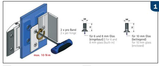
Bitte bei der Montage die Zapfen des Flügelteiles mittig in den Glasbohrungen positionieren, um den grösstmöglichen Verstellbereich für die Einstellung der Dusche zu gewährleisten.
