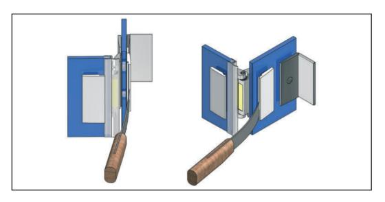
Hinweis zur Demontage der Abdeckkappen. Führen Sie bitte eine stabile, breite Klinge (z.B. Bleimesser) in den Spalt zwischen Gegenplatte und Abdeckkappe ein und hebeln die Abdeckkappe unter gleichzeitigem Nachführen des Messers ab.
