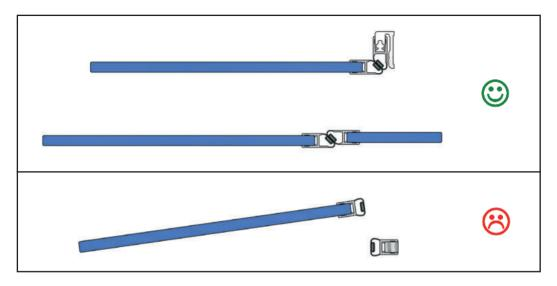
Wichtig: Die Bänder Papillon bitte nur mit Anschlagmagnetdichtprofil verwenden, um die Möglichkeit des Überdrückens zu verhindern! Beim Überdrücken können die Duschbänder beschädigt werden.
