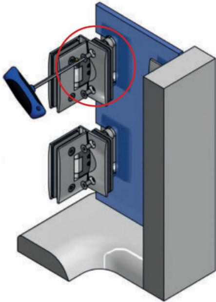
Die Dicke der einzusetzenden Hartzelleinlagen richtet sich nach der verwendeten Glasstärke:
