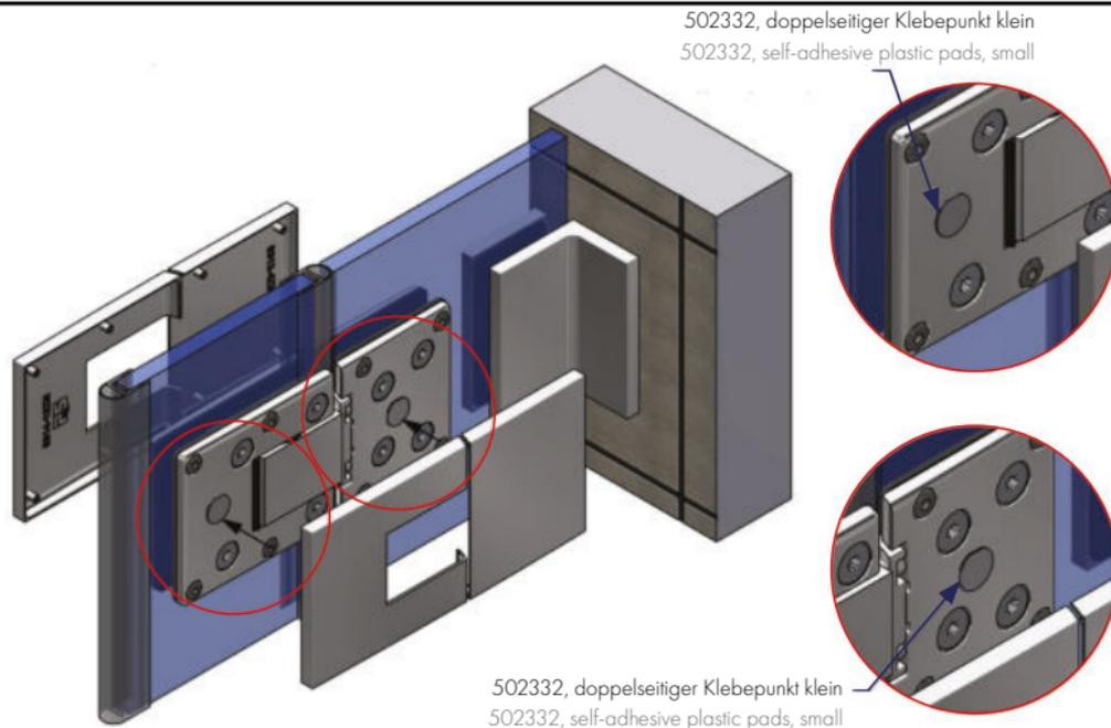
Zur Fixierung der Abdeckkappen 8314-13ZN und 8312-4ZN, diese mit den Zapfen in die vormontierten EPDM-Formteile stecken und andrücken.
