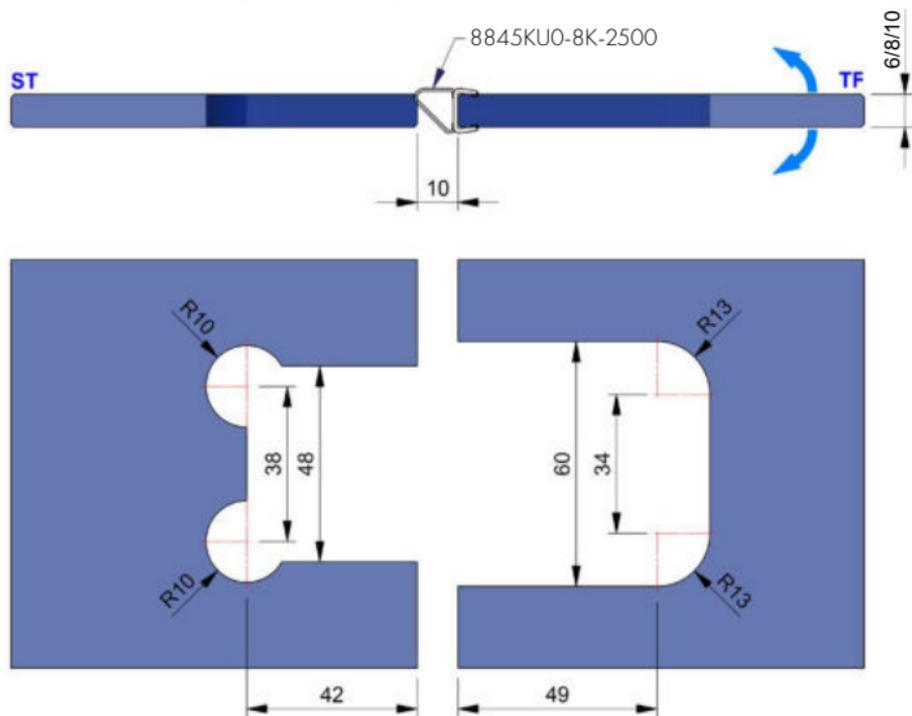
Glasbearbeitung mit Dichtprofil 8857KU0-8-2010
