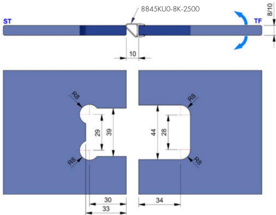
Glasbearbeitung mit Dichtprofil 8857KU0-8-2010
