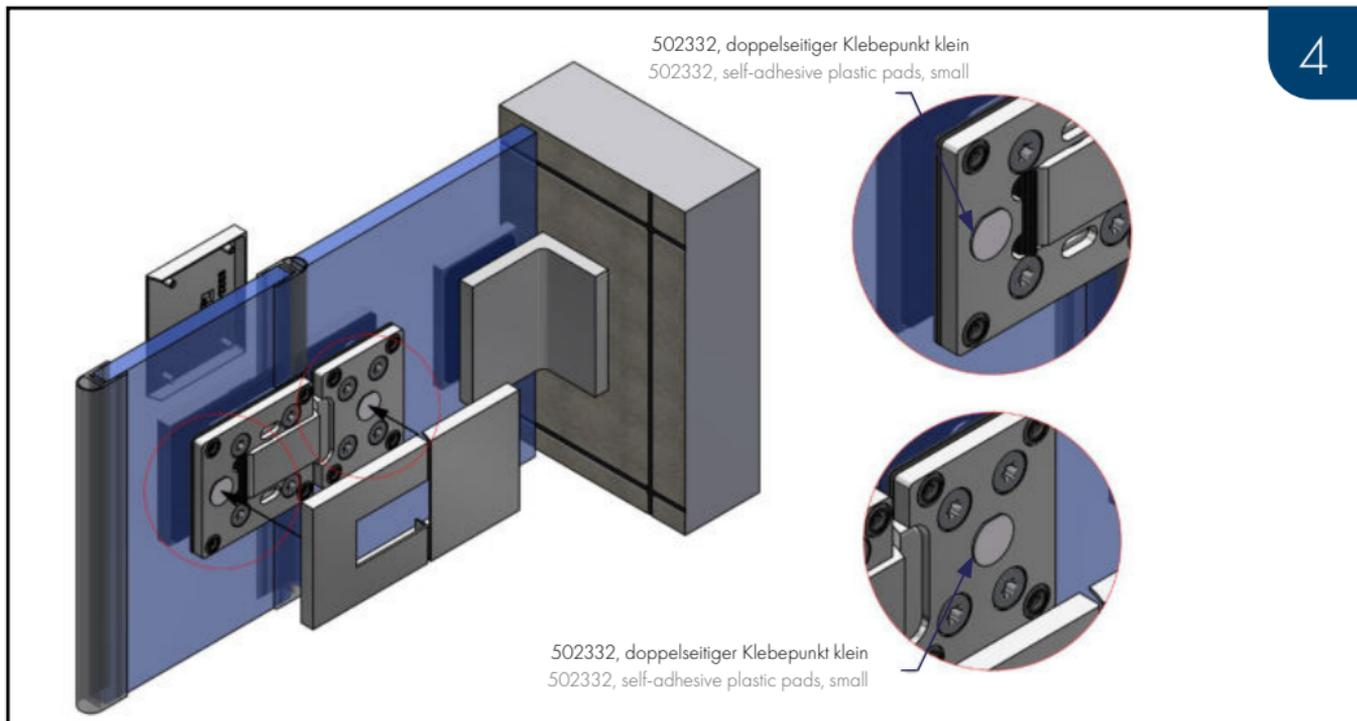
Zur Fixierung der Abdeckkappen 8330-2ZN und 8332-3ZN, diese mit den Zapfen in die vormontierten EPDM-Formteile stecken und andrücken.
