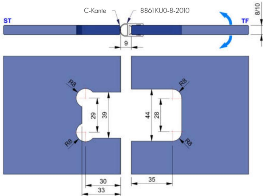
Je nach verwendetem Dichtprofil ist darauf zu achten, dass unterschiedliche Glasbearbeitungen zum Einsatz kommen.
